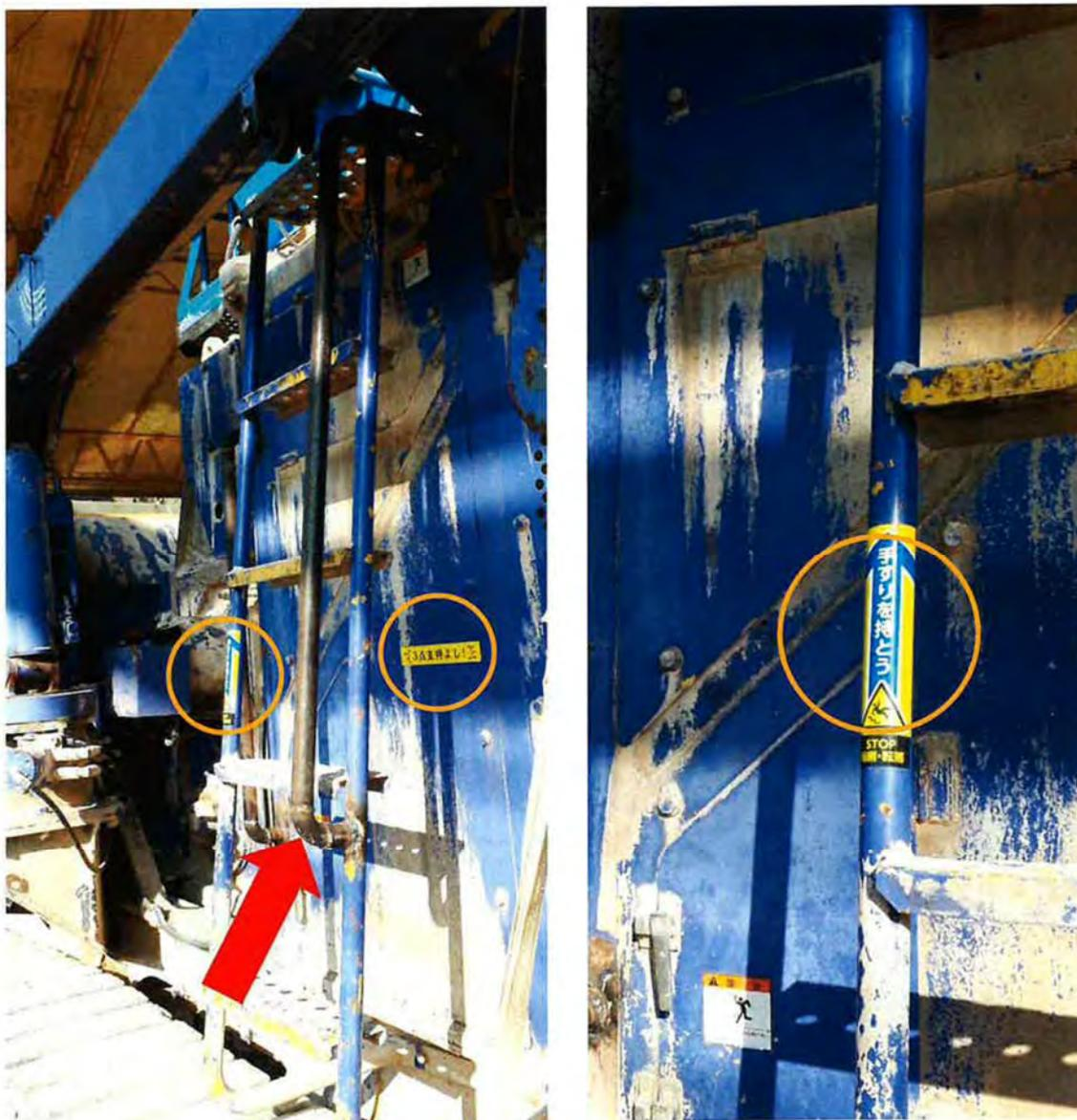
昇降タラップ右側支柱に手摺を追加して取り付け、昇降時の手の持ち替えによる墜落防止を図り、注意喚起の表示も行った。
