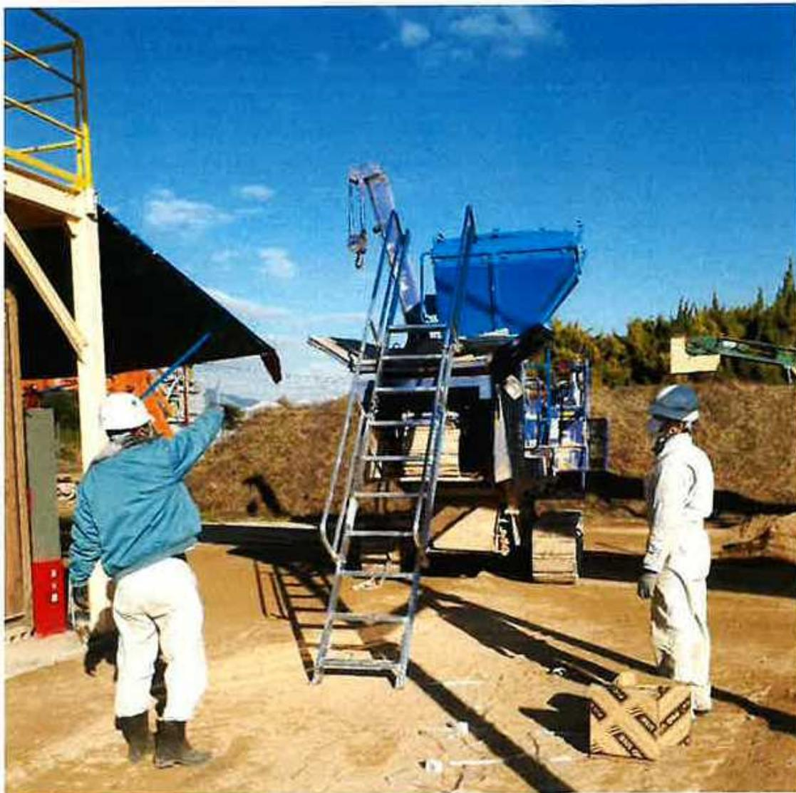
令和4年1月8日、改良機の原料ホッパー後方にアルミ製昇降階段を設置。
