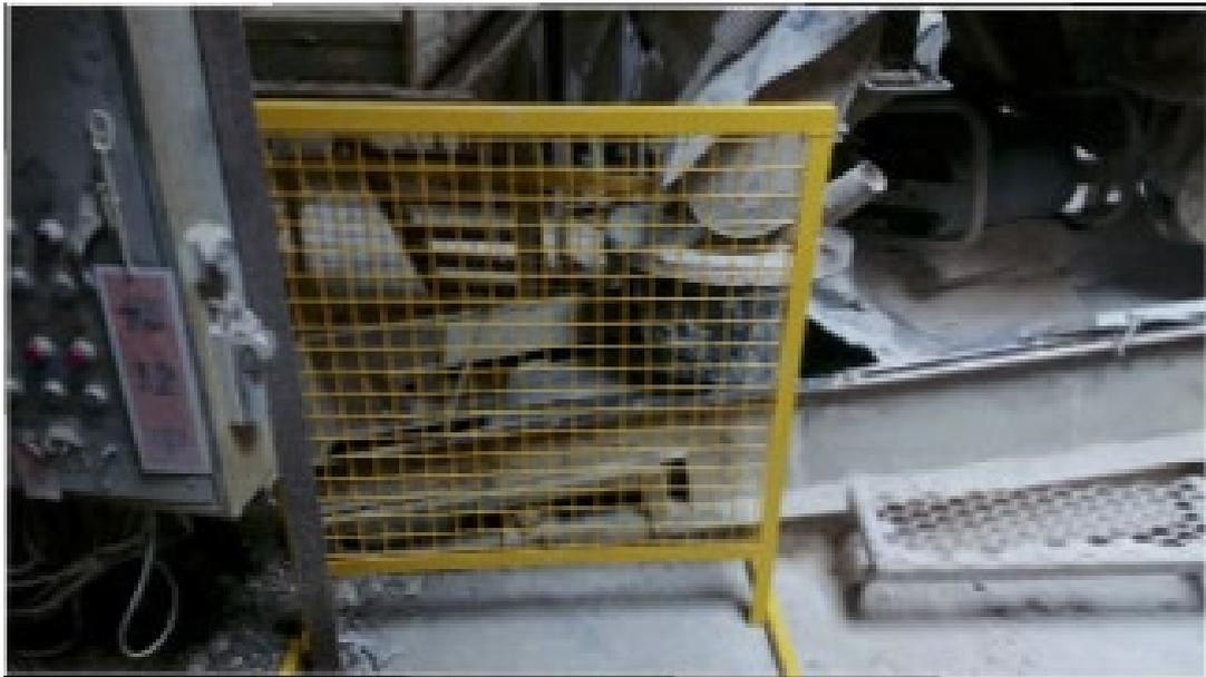
対策2:ベルトコンベア作業側へ囲いの設置
