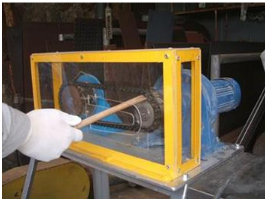
チェーンとスプロケットの間に 竹棒を巻き込ませる
