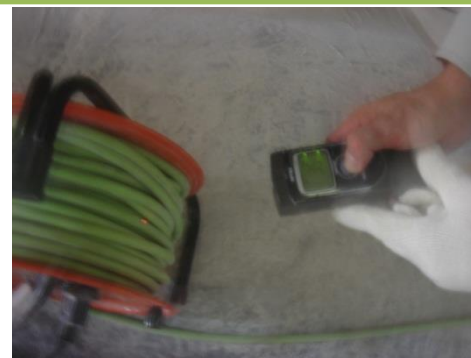
コードリールの表面温度を測定
