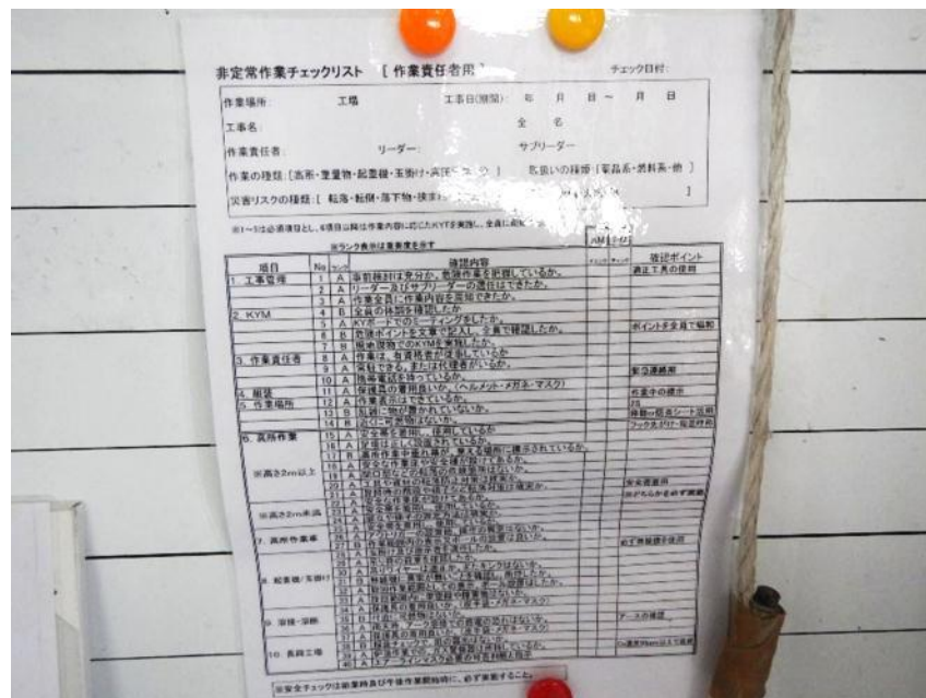
非定常作業前チェックリスト(作業責任者用) ダブルチェック式になっており、チェック項目の確認ポイントの説明も記載。
