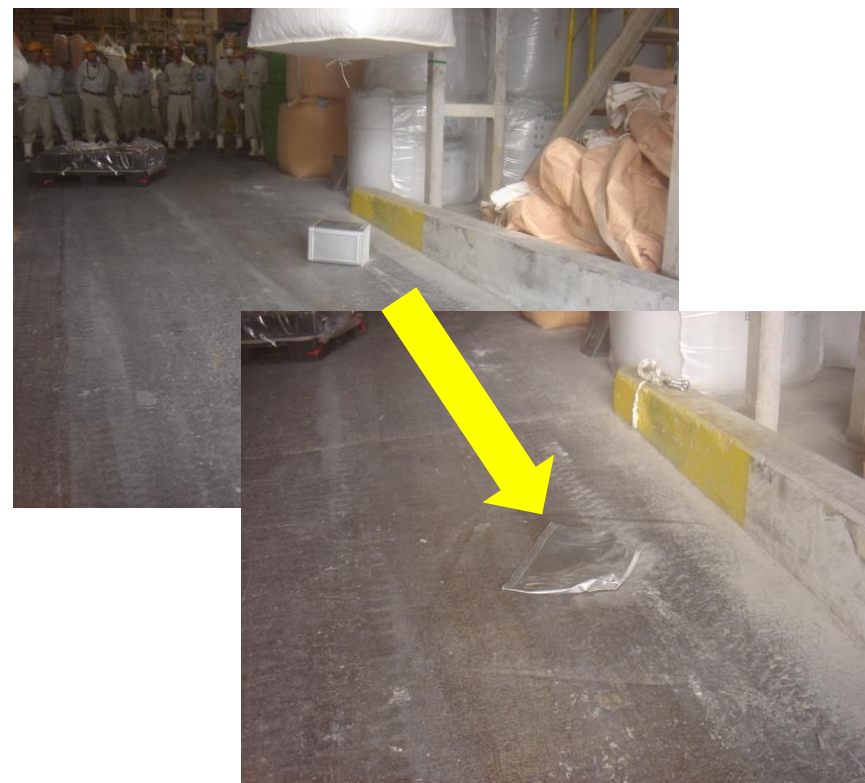
一斗缶が下敷きになり完全に潰れる
