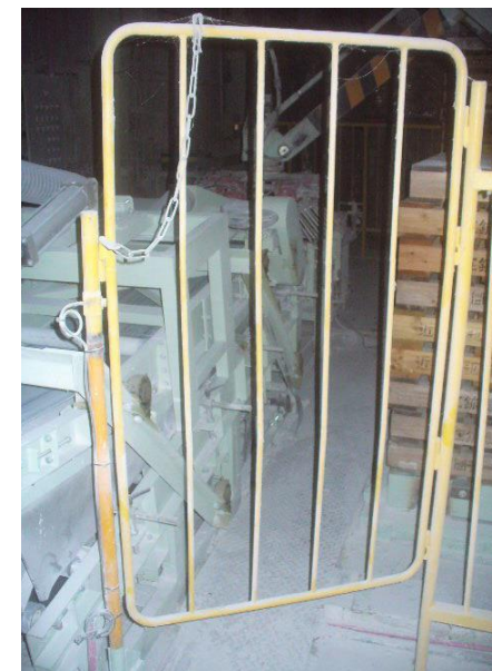
柵のドアを開けるとロボットが停止しパトライト作動
