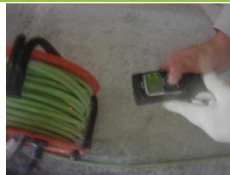
コードリールの表面温度を測定
