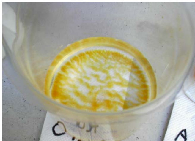
写真3-2 : 高分子凝集剤により形成されたフロック
