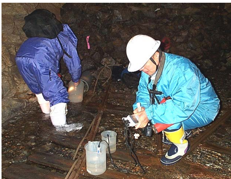
写真1-2 : 坑内水の pH 測定
