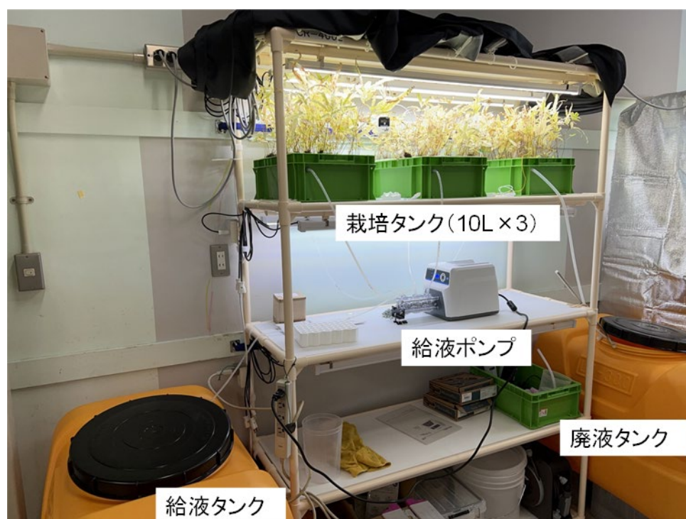
図 2.4-21 連続処理試験装置の全体像
