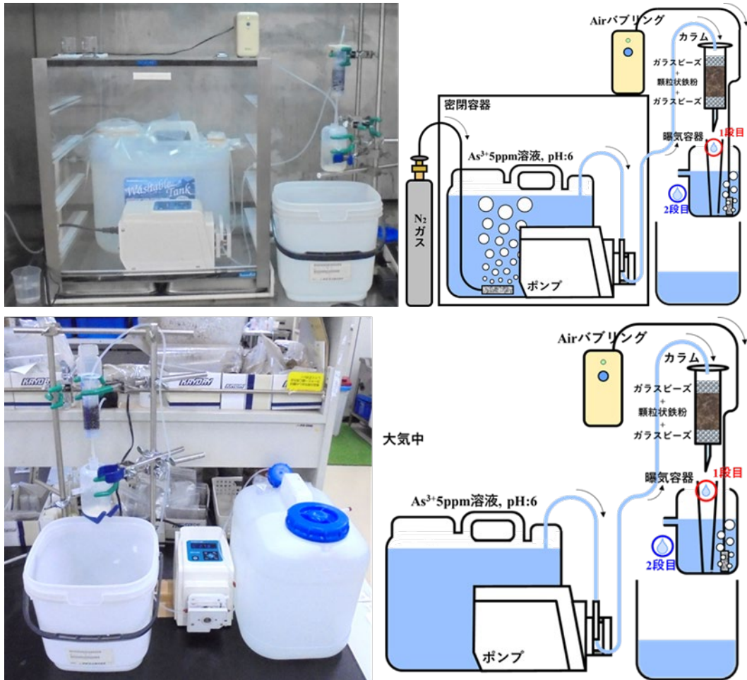
図 2.4-4 室内通水試験の様子と模式図と採水箇所（模式図中）
