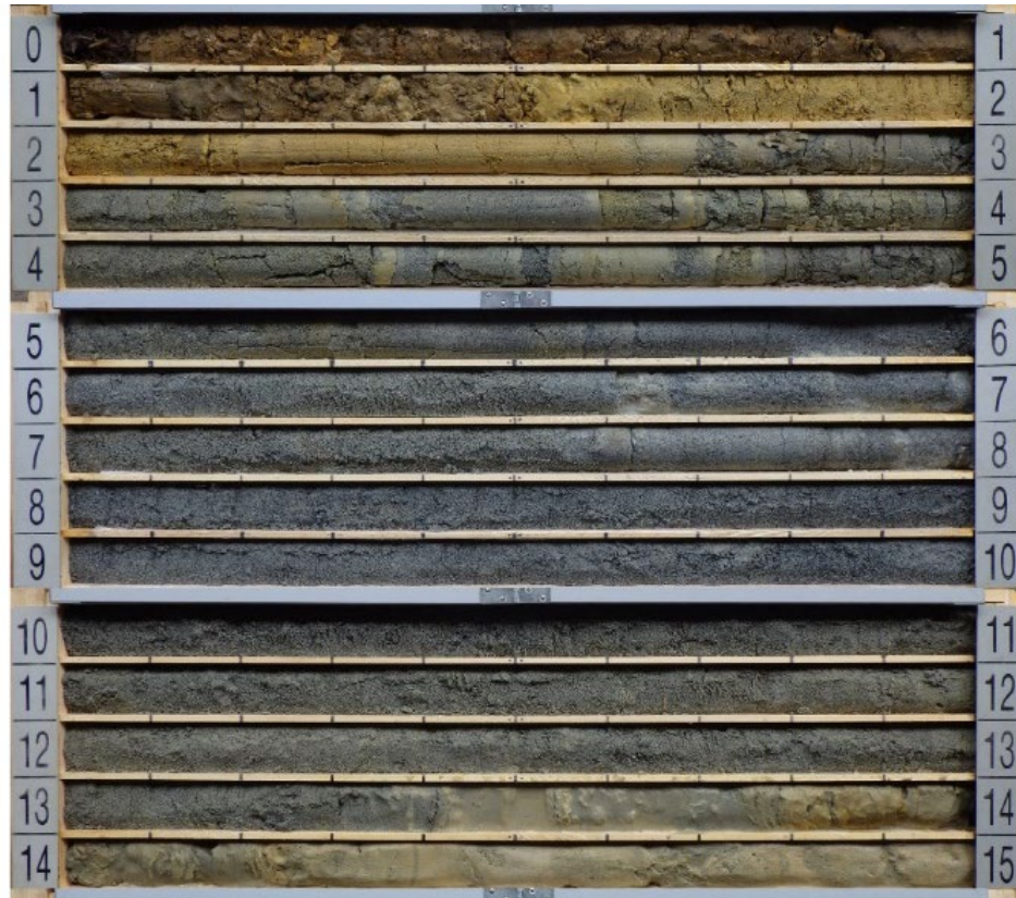
図 4-4 調査ボーリングで得られたボーリングコア試料
