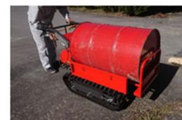
少人数での作業効率向上のため、中和剤貯蔵タンク投入用輸送設備を設置。中和剤20トン（約4週間分）をフレコンバグで備蓄。また、重量物運搬用のキャリアダンプを配備。
