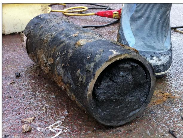
継手部（機械式接合（拔出防止有））の損傷（液状化による被害）
