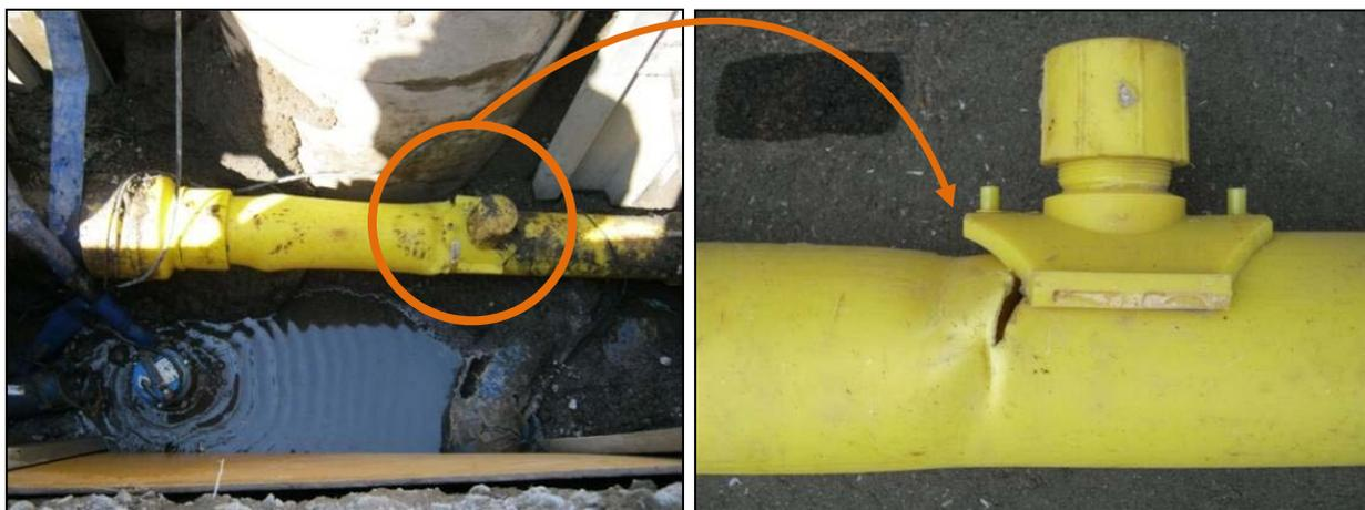
PE（150mm）サドル部の損傷（部分的な融着不良を起因としたもの）
