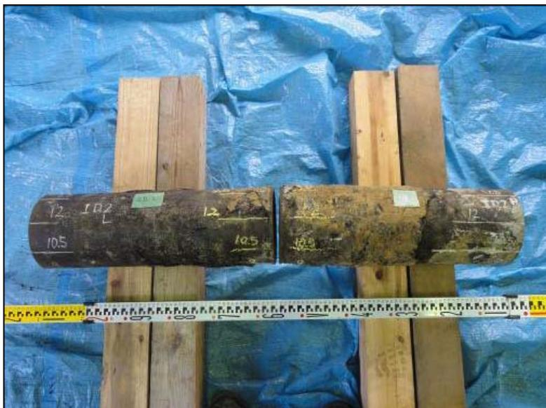
溶接部（非裏波溶接）の損傷
