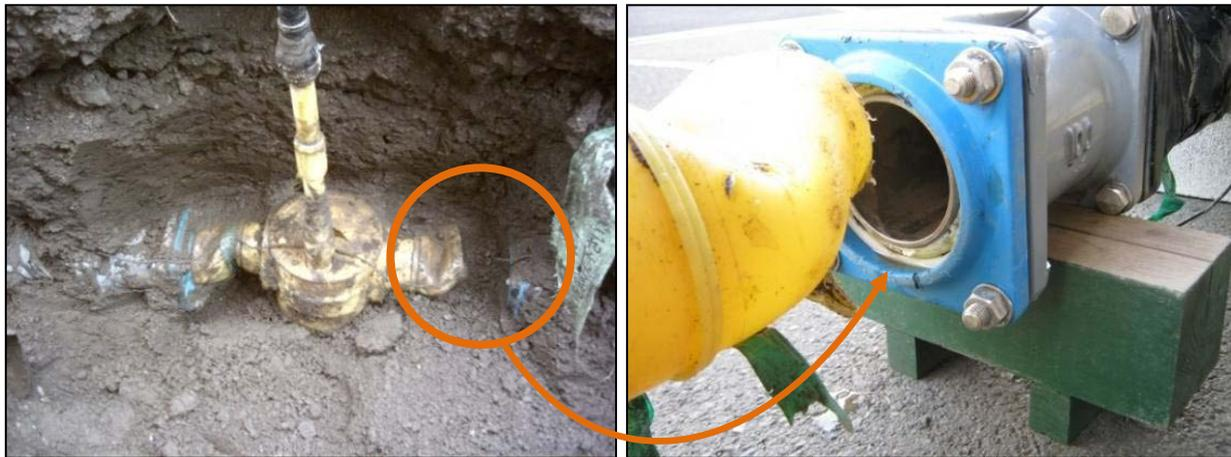
PE 製水取器の袖管部（100mm）と鋼管の機械的接合部の損傷
