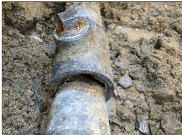
継手部（ねじ接合）の損傷（地震動による被害）
