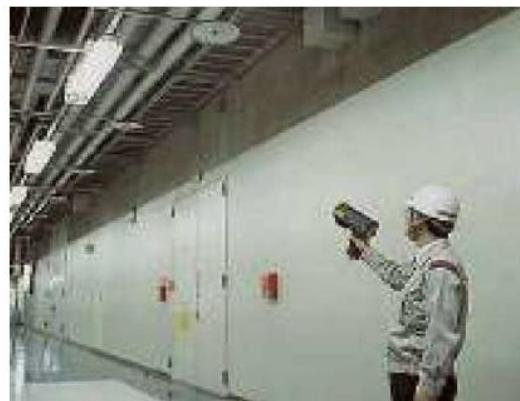
レーザーメタン検知器を用いた天井ガス配管の漏えい検査
