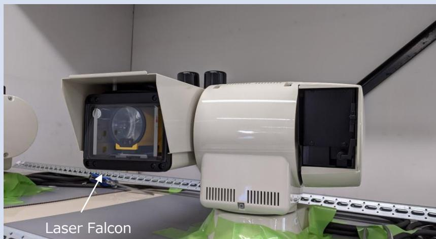
レーザーファルコンを搭載した定置型漏洩監視システム
