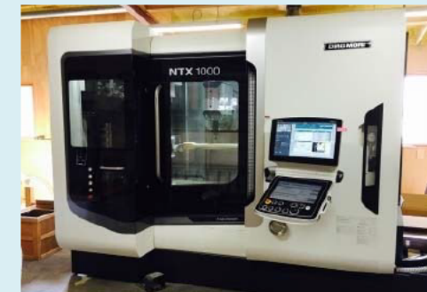
NC工作機械 (DMG森精機製 複合加工機)
