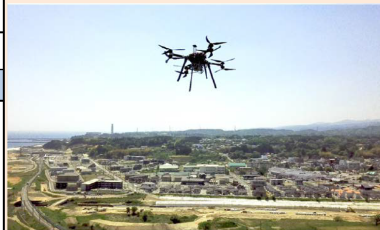
3Dレーザースキャナを搭載したドローンで空間情報を計測
