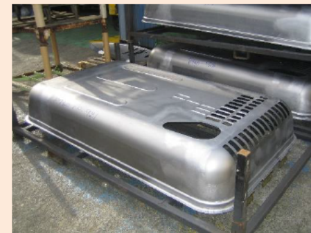
(製品)深絞り技術が用いられた大型ショベルカー用のエンジンフード
