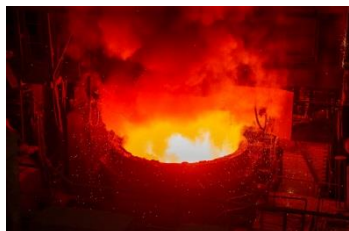
鉄スクラップをリサイクルする環境負荷の少ない電気炉
