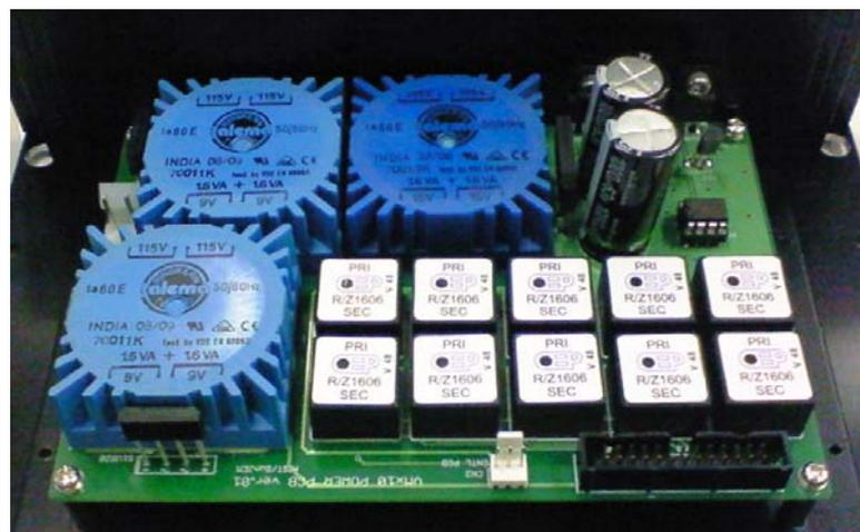
図 3-18 VMx10 モジュール電源回路
