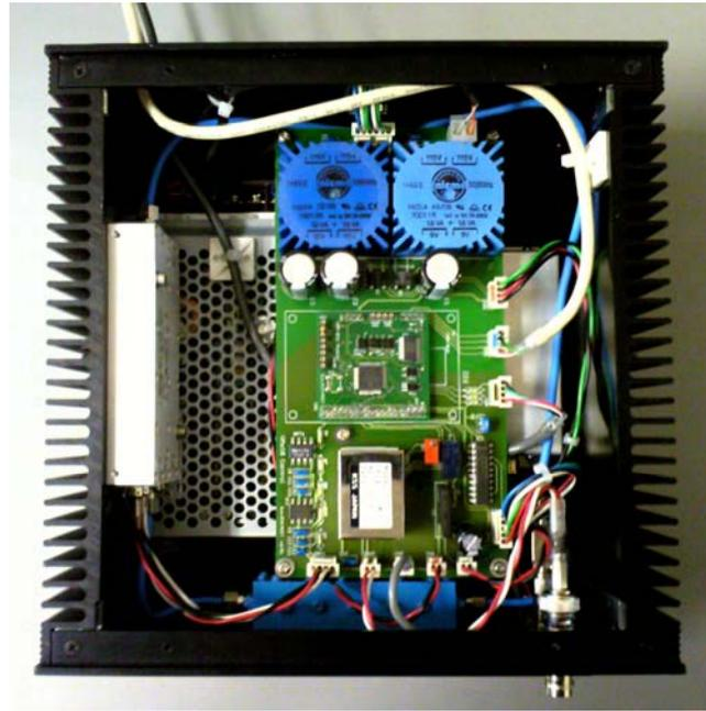
図 3-17 RF モジュール(マイクロ波出力回路)
