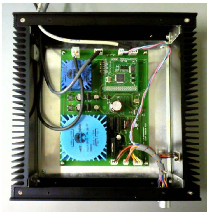
図 3-1 5 TEMP モジュール(温度制御回路)
