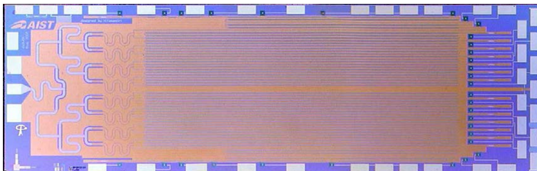
図 3-13 電圧標準チップ写真 (14.7 mm×4.7 mm)
