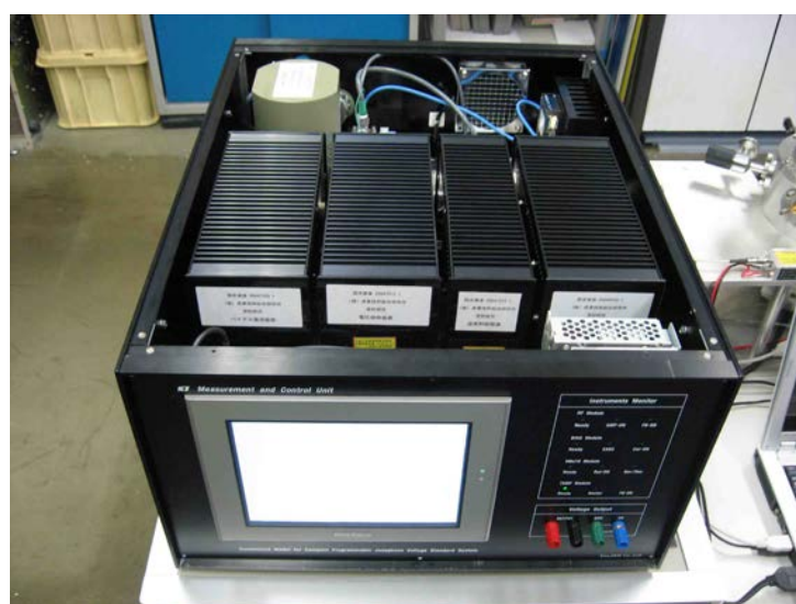
図 3-20 小型ジョセフソン電圧標準システム
