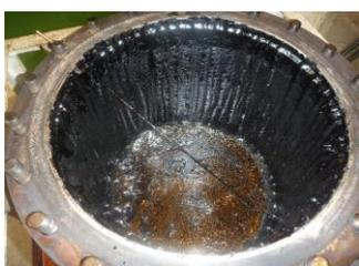
バインダー溶液蒸溜装置の製品回収容器を開放したところ。底部に見える茶色の物質が新規バインダー。
