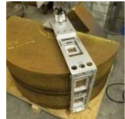
オーバーパック溶接部の 非破壊検査装置
