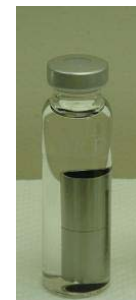
照射済みBWR燃料被覆管の浸漬試験の様子
