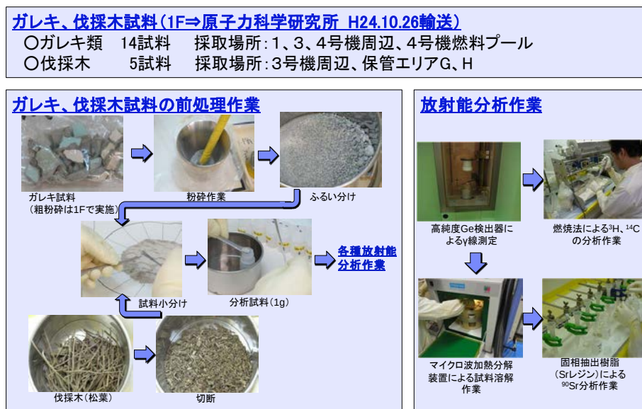
図3-18. ガレキ、伐採木試料の輸送、前処理、分析
