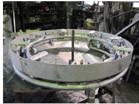
図 3 - 5 3. 塩水噴射・スラリー吸引部の構成と製作状況
