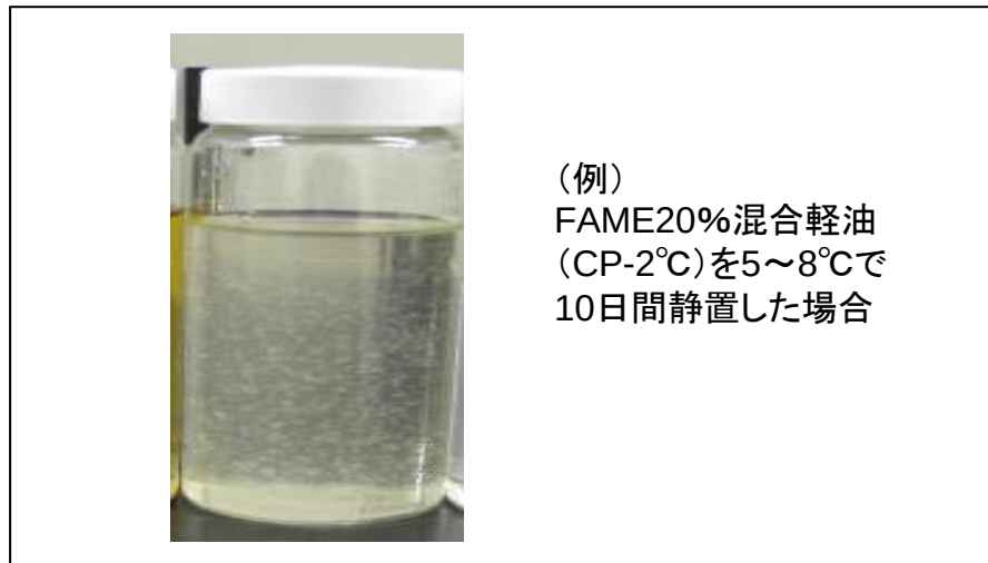
図 3-1-9 常温での固形物の析出状況
