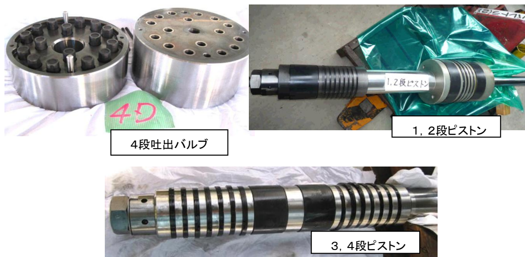
図 3 - 1 0 圧縮機部品分解点検
