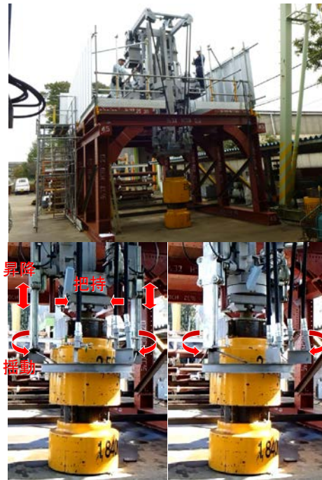
図 3 - 5 4. 塩水噴射部昇降設備の構成と製作状況
