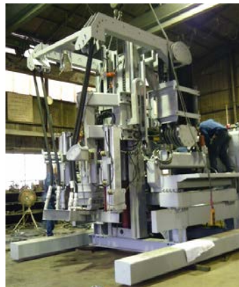
図 3 - 5 4. 塩水噴射部昇降設備の構成と製作状況
