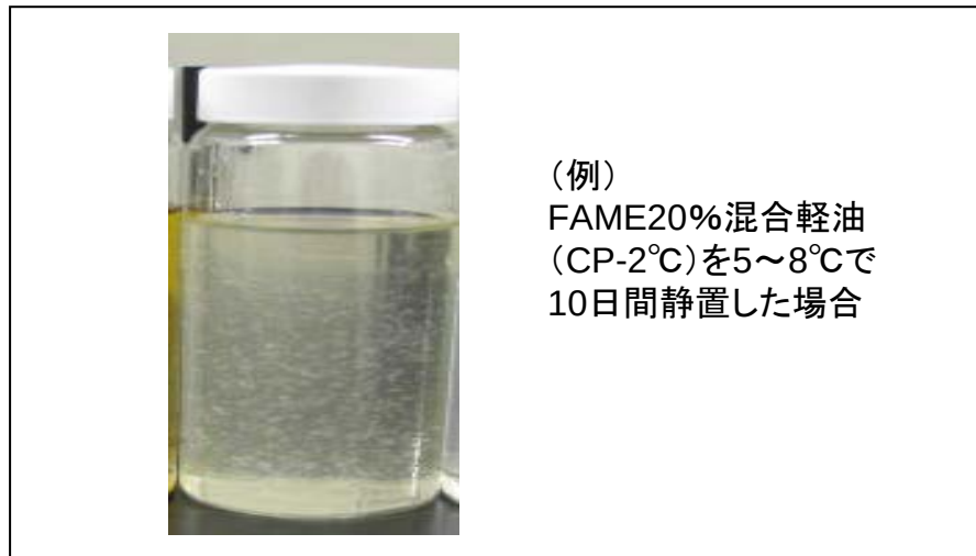
図 3-1-9 常温での固形物の析出状況
