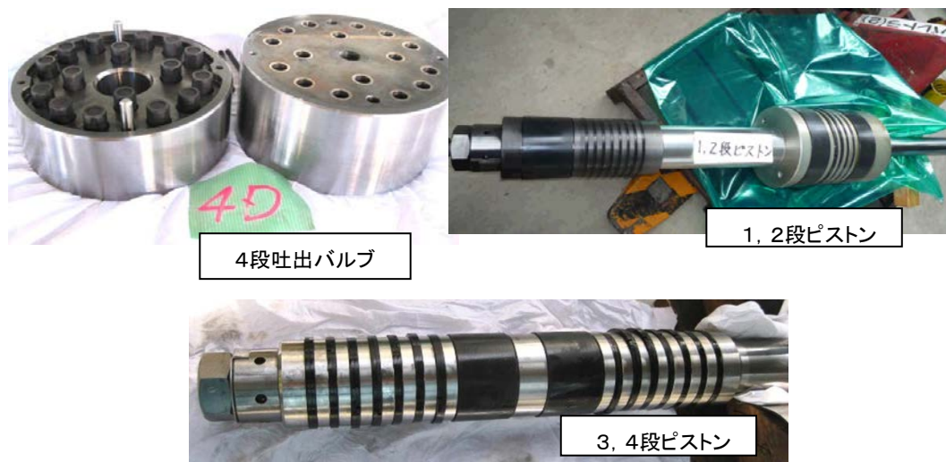
図 3 - 1 0 圧縮機部品分解点検
