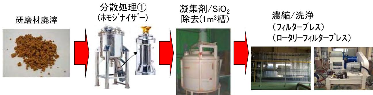
図 3-2 化学的処理工程の流れ
