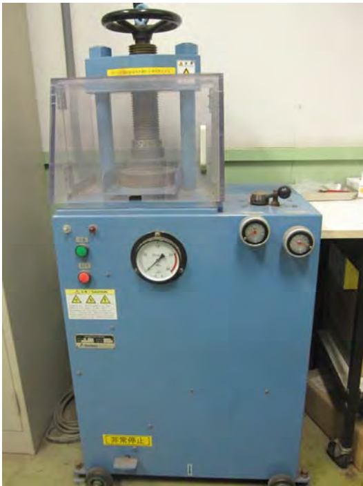
写真 3-8 成型圧縮機 BRE-32
