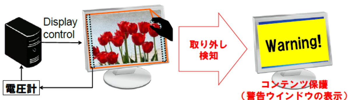
図 d-5 取り外し検知センサーシステムの概要
