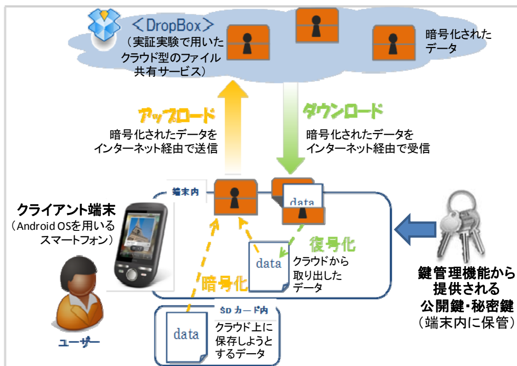
図 e-2 実証実験で用いたクライアント端末とクラウドサービスの構成イメージ
