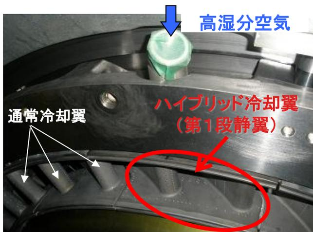
図1 ハイブリッド冷却翼組込写真
