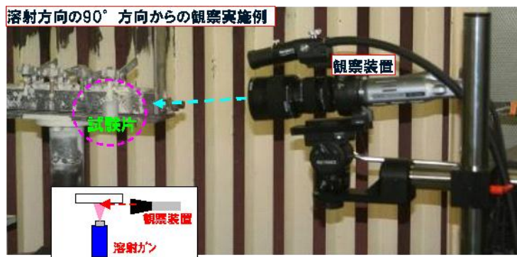
図7 溶射状況の高速度カメラ撮影
