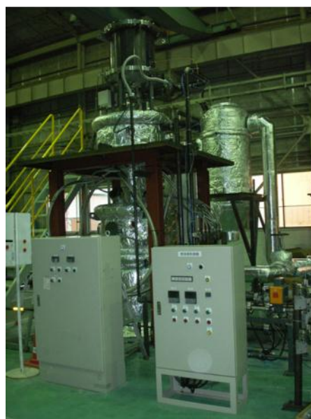
図8 高温高速エロージョン試験装置
