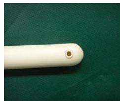
図 30 ファイバー式ガス温度計測プローブ
