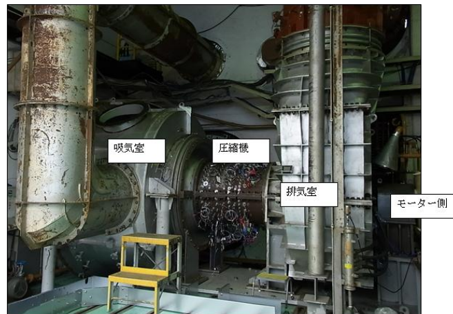
図 2 1 圧縮機前方段の高速回転試験装置
