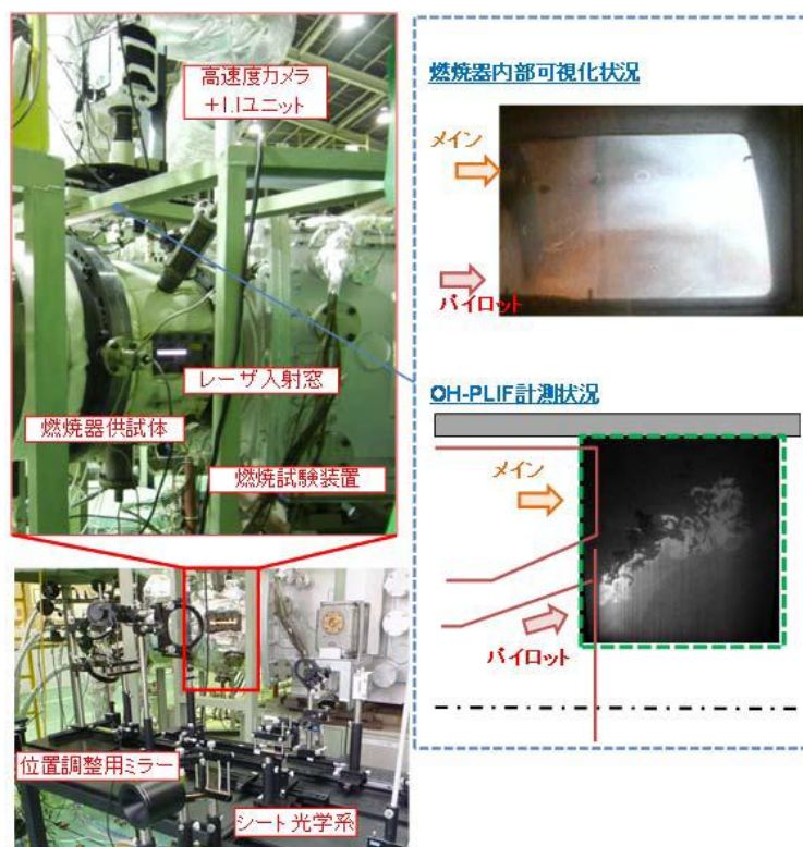
図 1 3 実燃焼器でのレーザーによる 火炎計測状況 (図中 I.I : Image Intensifier)
