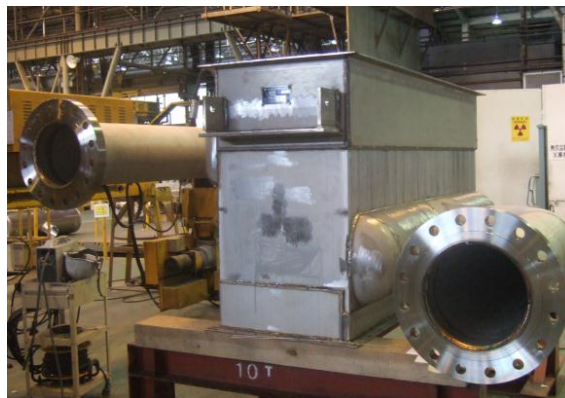
再生熱交換器本体
