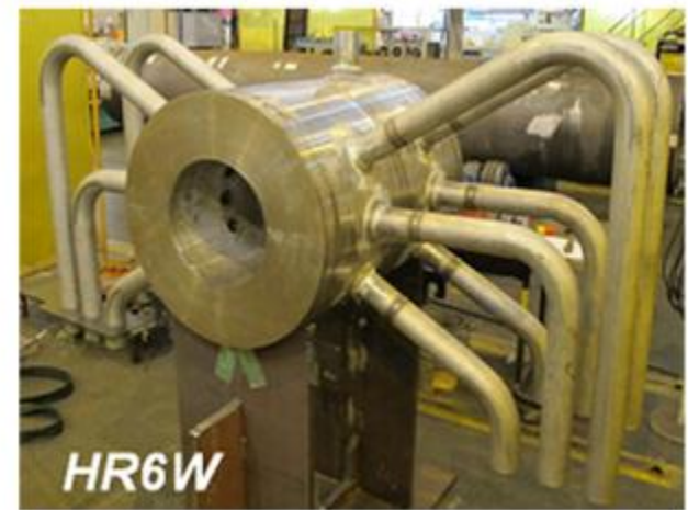
図3-8 再熱器、過熱器ヘッダーモックアップ
