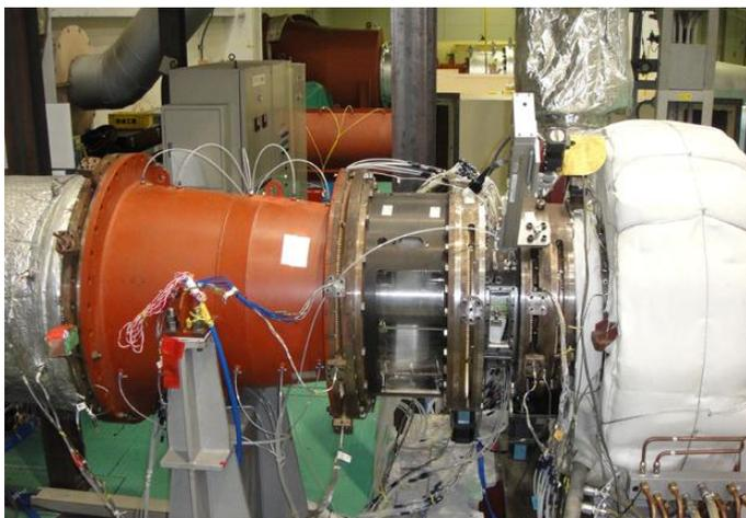
図 1 6 ディフューザ試験装置(上)
