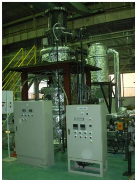
図8 高温高速エロージョン試験装置
