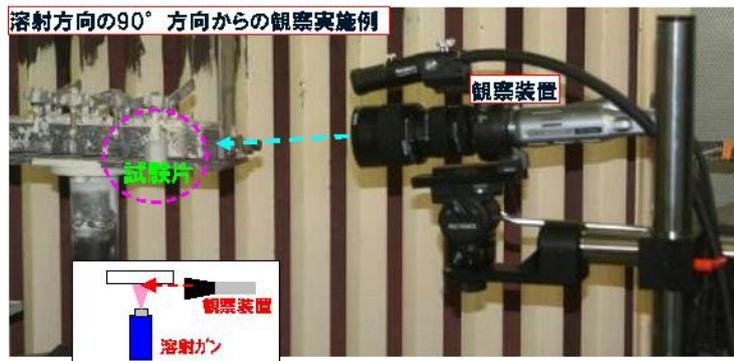
図7 溶射状況の高速カメラ撮影
