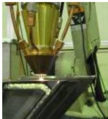
図 2 8 冷却通路の溶接状況(レーザー工法)
