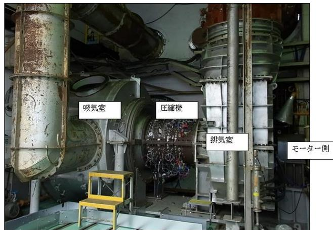
図 2 1 圧縮機前方段の高速回転試験装置
