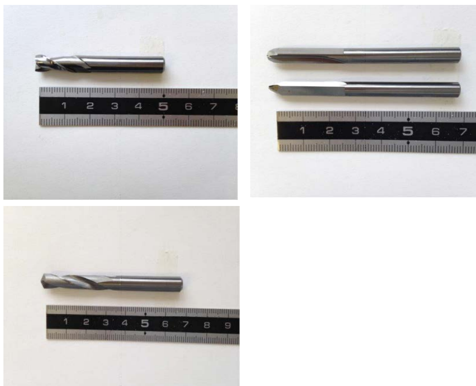
図 2－13．作製した試験用工具 このあとコーティングを行い、評価試験を行う。
