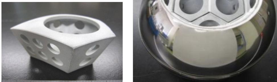
図3-3 中空ユニット、及びアセンブリの外観（RBSN 製、1/4 スケールモデル）
