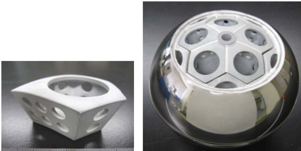
図 3-3 中空ユニット、及びアセンブリーの外観（RBSN 製、1/4 スケールモデル）
