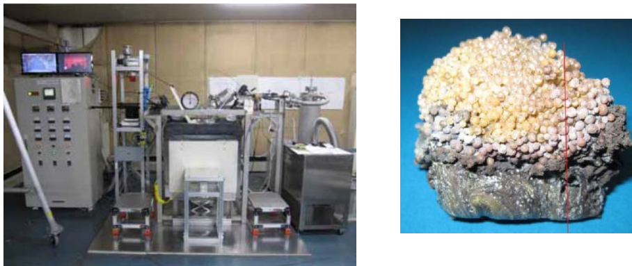
図 27 小型溶融炉外観（左）およびサンプリングした仮焼層（右）
