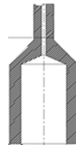
図 8 エアパーージ式液位計先端
