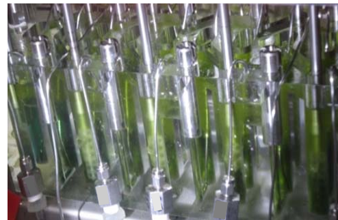
図 1 3 プルトニウム逆抽出の様子
