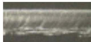
不良な切断面例（ドロス付着）
