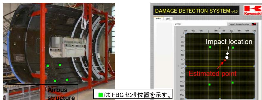
図3-5 Composite fuselage panel供試体及び衝撃損傷検知結果
