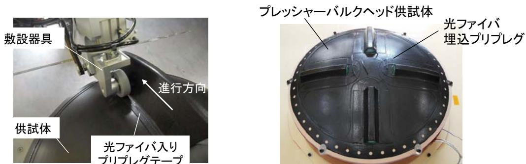
図3-14 光ファイバ自動敷設実証試験結果
