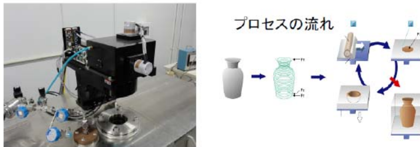
図 3-29 レーザフォーミング装置とプロセスの流れ
