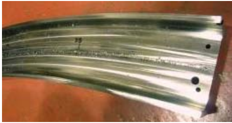
図 3-16 模擬部材(型材溶接後)
