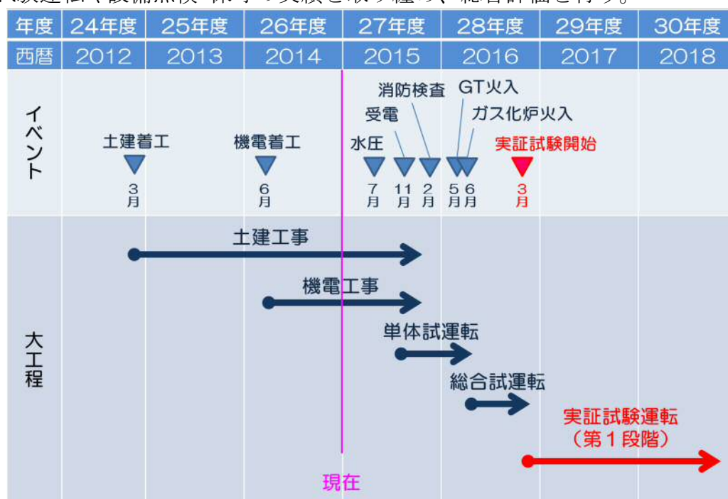
図 2-17 試運転・実証試験工程
