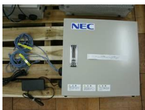
図3-53. NEC製通信アダプタ装置 (試作機)
