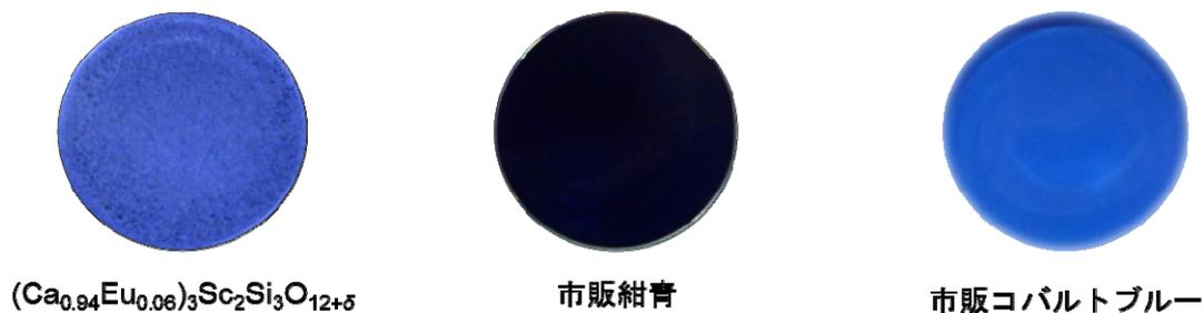
図 3-6  $(\text{Ca}_{0.94}\text{Eu}_{0.06})_3\text{Sc}_2\text{Si}_3\text{O}_{12+\delta}$ 、市販紺青、及び市販コバルトブルーの写真
