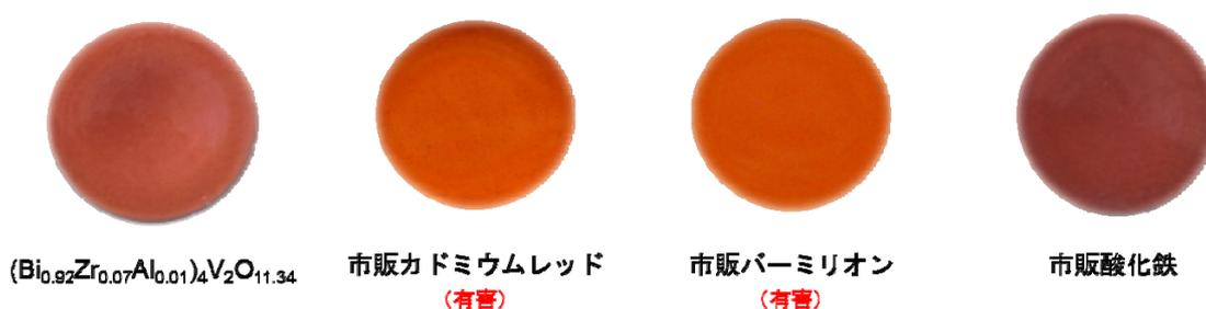
図 3-4  $(\text{Bi}_{0.92}\text{Zr}_{0.07}\text{Al}_{0.01})_4\text{V}_2\text{O}_{11.34}$ 、市販カドミウムレッド、市販パーミリオン、及び市販酸化鉄の写真
