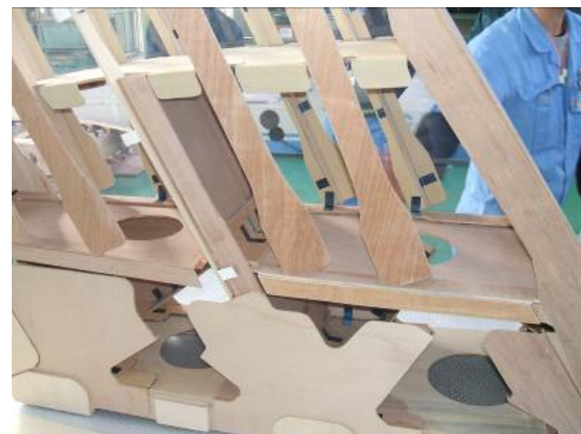
垂直尾翼桁間翼根周辺部
