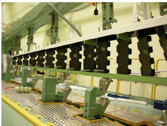
図3-11. 工作試験の様子（SPARとRIBの組み付け検証）
