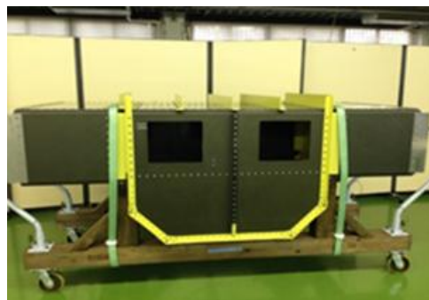
図3-16 翼胴結合供試体
