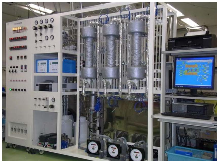
図 3-20 CO<sub>2</sub> 小型連続回収試験装置
