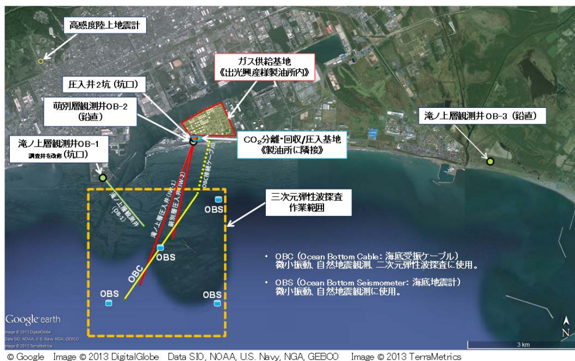
図 3-8 圧入およびモニタリング設備の配置
