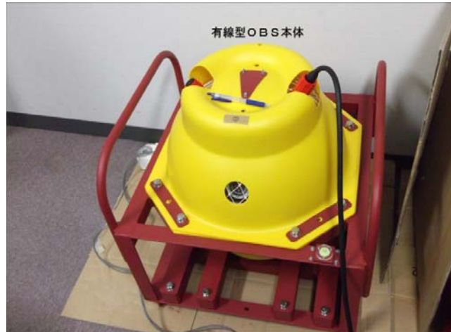
図 3-48 有線型OBS本体の外観写真
