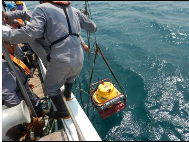
図 3-52 OBS 本体の設置作業
