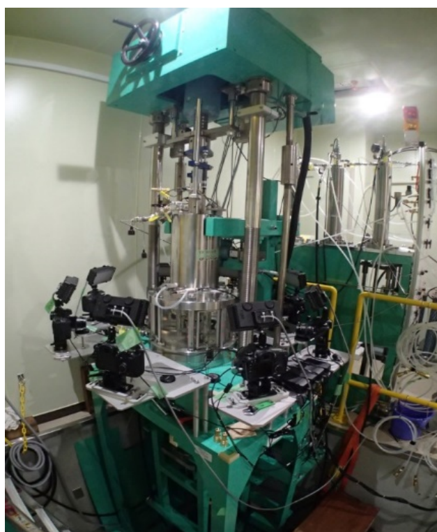
PNATs-TACCT : 三軸型保圧力学装置
