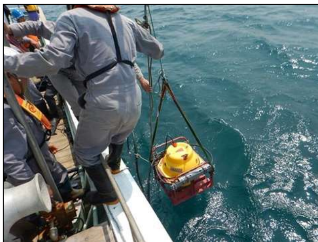
図 3-53 O B S 本体の設置作業
