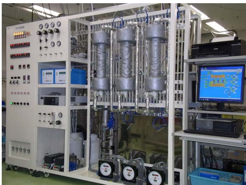
図 3-20 CO 2 小型連続回収試験装置
